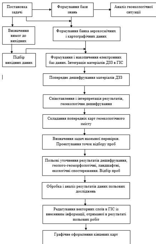
Рис.1. Принципова технологічна схема обробки і інтерпретації ДЗЗ при використанні для цілей екологічного моніторингу
